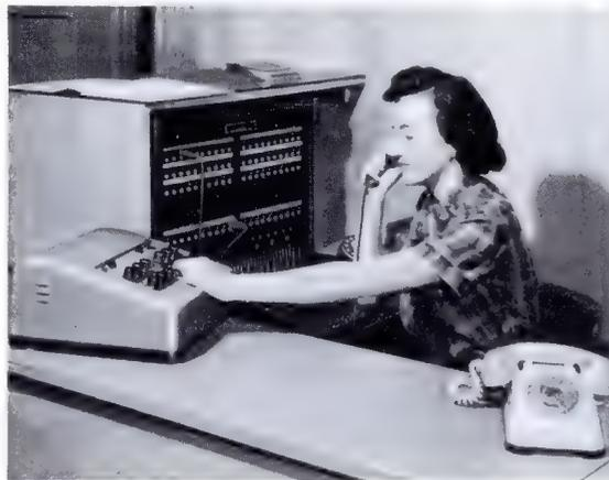
Bild 1. Modulationsgerät mit Zahlencodiereinrichtung für den Pagemaster-Sender in einer Fernsprechkentrale
