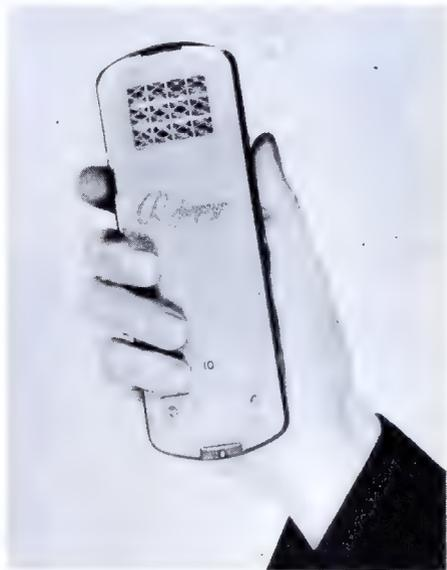
Bild 3. Radiopage-Empfänger mit kleinem Kristalllautsprecher
